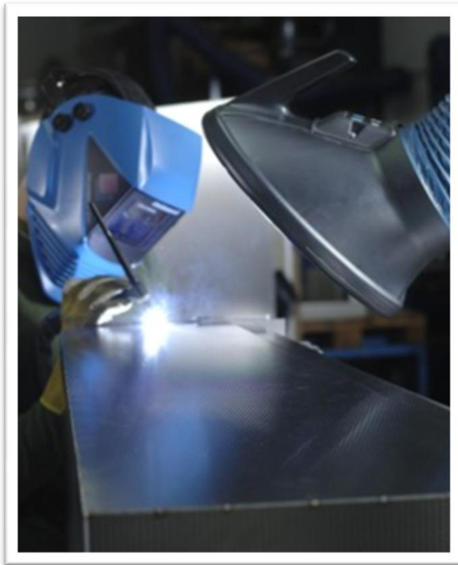
Situação real de exaustão com captor localizado
